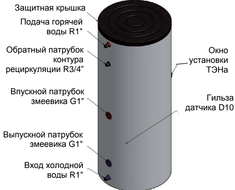
Водонагреватель с двумя теплообменниками-змеевиками 160-200 л
