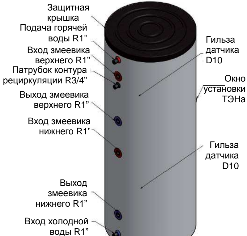
Водонагреватель с двумя теплообменниками-змеевиками 160-200 л
